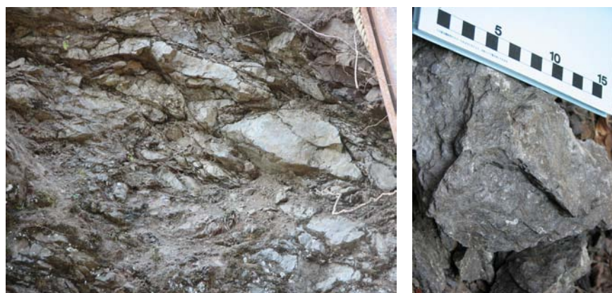
写真-1. レンズ状のブロックを含む混在岩（左）と、泥岩の鱗片状劈開と鏡肌（右）
